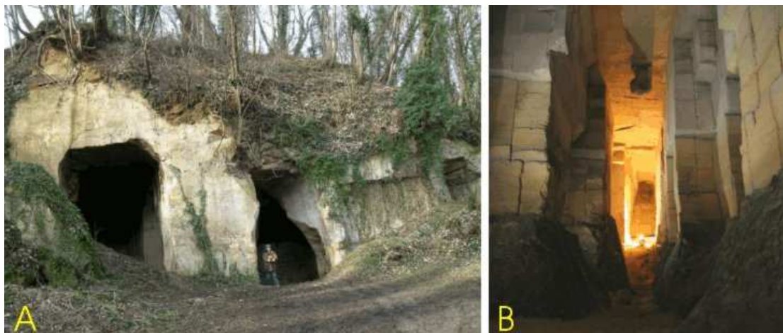
A: entrée des exploitations souterraines dans la craie de la Formation de Gulpen (Campanien-Maastrichtien), à Lanaye, au nord de Visé. B: vue d'une des galeries des carrières souterraines. Le bloc au plafond est un silex . Photo L. Willems.
